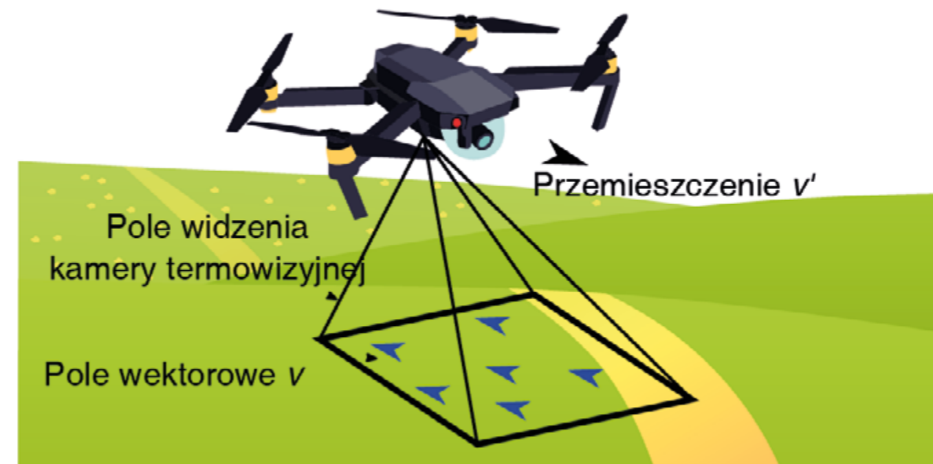
Koncepcja kamery termowizyjnej do nawigacji drona analizująca pole wektorowe przesunięć obiektów na powierzchni ziemi
