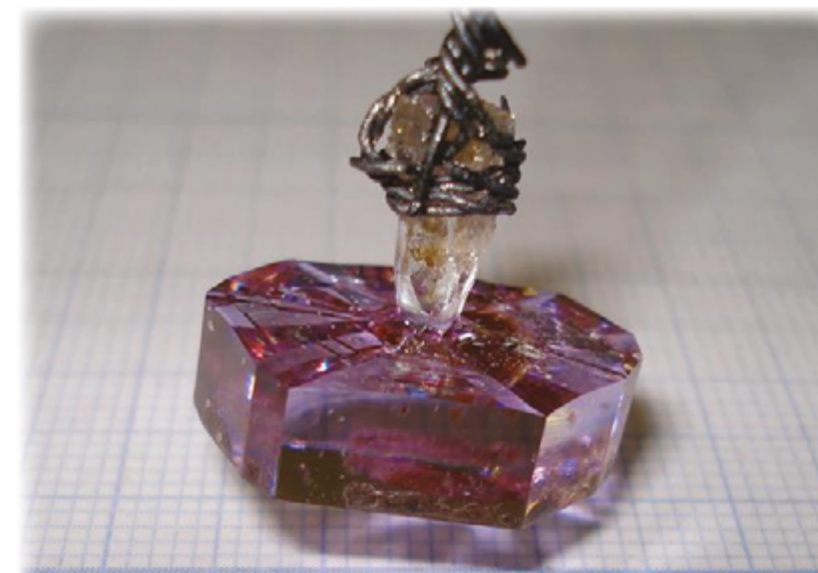
Monokryształ boranu bizmutowo cynkowego domieszkowanego neodymem otrzymany metodą Kyropoulou
